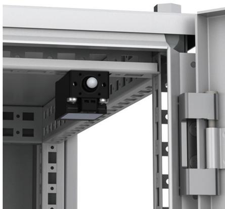
**Descripción:** Interruptor de puerta para activar cualquier dispositivo eléctrico (iluminación, señalización, alarmas, etc.). Se puede montar después de instalar el armario manteniendo así la apertura libre de la puerta. Se monta en los taladros interiores del marco de la puerta de armarios autoportantes. Entrada de cables M20.
