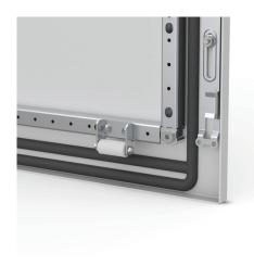
**Descripción:** Para nivelar la puerta al cerrarla cuando instalamos equipamiento pesado como equipos de aire acondicionado, etc. Montada directamente en la parte inferior del marco de la puerta. Muy recomendada cuando fijamos a la puerta una carga superior a 30 kg.
